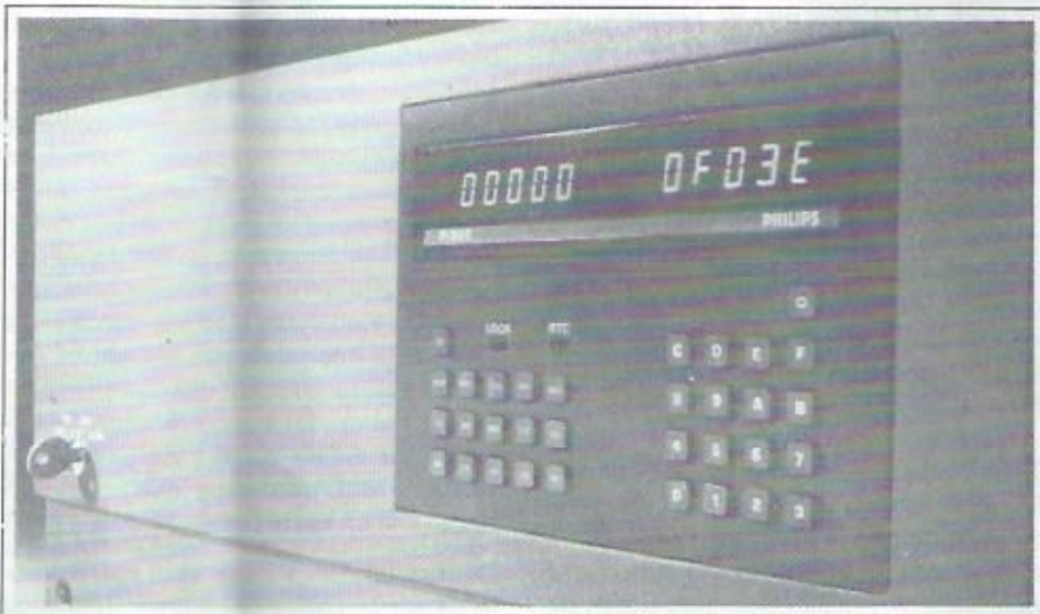
De P858 minicomputer met een 256k kernengeheugen.
